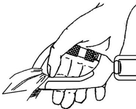
Рисунок 2– Проверка блокировки карабина
