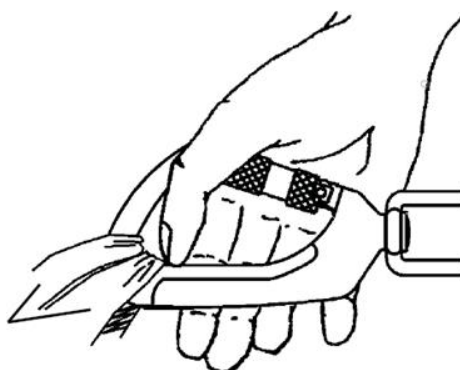
Рисунок 2– Проверка блокировки карабина
